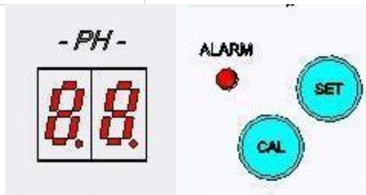
Πίνακας χειρισμού: Οθόνη pH, κουμπί SET, κουμπί CAL, LED ALARM
