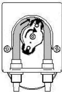
Θέση αποθήκευσης — ρολός στην πλευρά κατάθλιψης
